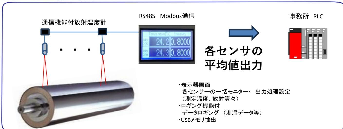
熱電対の校正用実温入力より自動的に放射率が設定 (更新)
